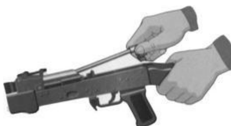
Рисунок 12.5 - Отделить возвратный механизм
