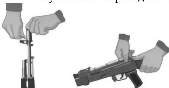
Рисунок 12.3, 12.4 - Отделить шомпол и открыть крышку шомпол ствольной коробки
