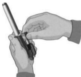
Рисунок 12.7 - Отделить затвор от затворной рамы
