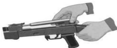
Рисунок 12.6 - Отделить затворную раму с затвором
