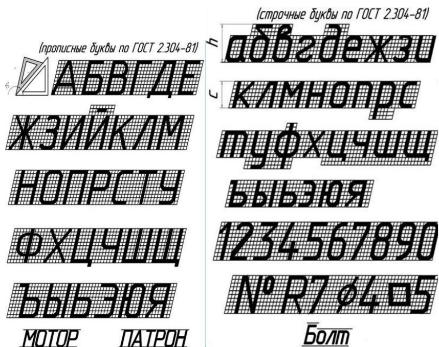
Рис. 1 Чертежный шрифт тип Б с наклоном по ГОСТ 2.304-81*
