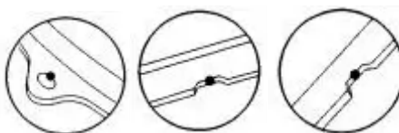
Точка привязки А Точка привязки В Точки привязки D–K. Рисунок 3 - Геометрические точки привязки размеров
