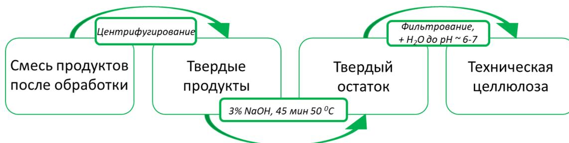
**Рисунок 1.** Схема выделения технической целлюлозы после обработки в среде глубокого эвтектического растворителя
