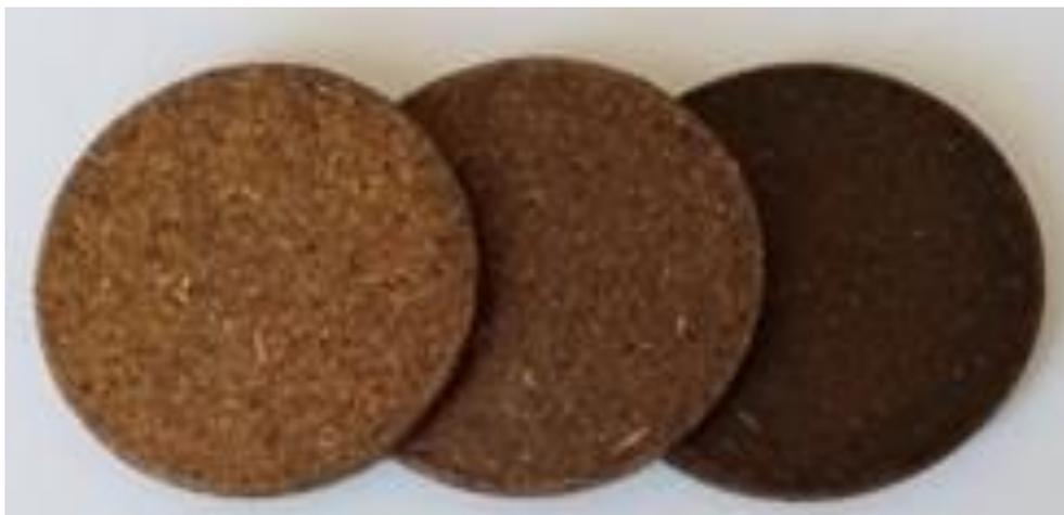
**Рисунок1.** Внешний вид дисков из соевой шелухи с пластификатором (12%)
