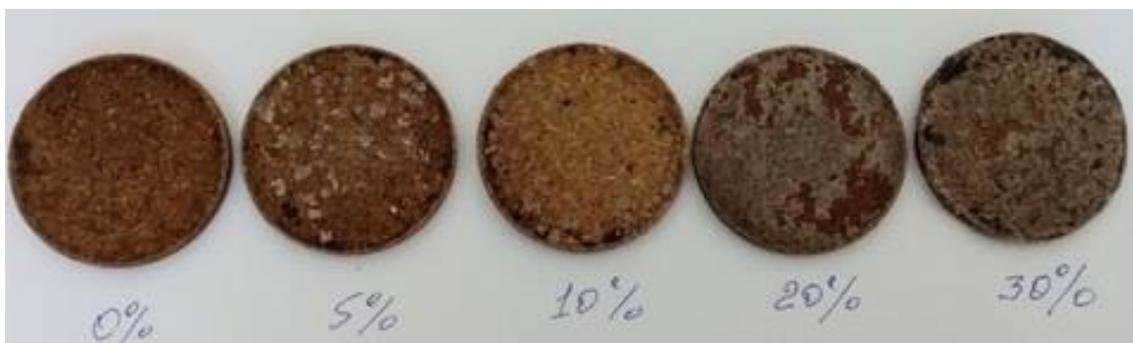
**Рисунок 1.** Внешний вид дисков из соевой шелухи с пластификатором (12%) и полипропиленом
