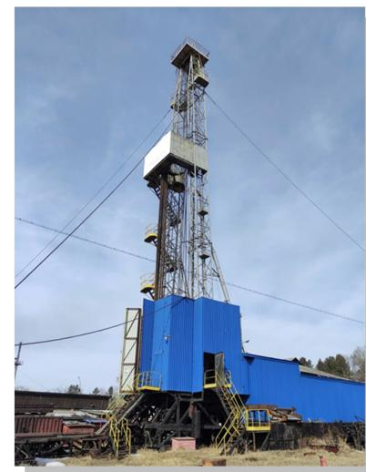
Для получения и закрепления практических навыков работы (СПО, обслуживание силовых агрегатов САТ-450, буровых насосов БрН-1, компрессоров КТ-6, оснастки талевой системы и т.д.) на бурении геологоразведочных и эксплуатационных скважин, на промплощадке при ИРНИТУ смонтирована **буровая установка БУБоБрД** грузоподъёмностью до 50т и глубиной бурения до 3000м.
