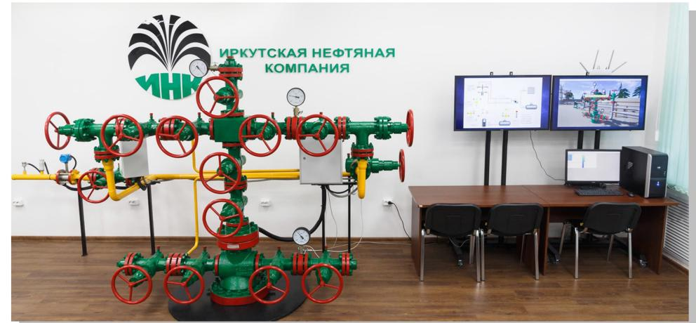
Управление предусмотрено с помощью физического макета и виртуальной трехмерной сцены газового месторождения.
