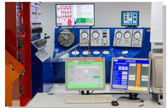
Программное обеспечение тренажера позволяет изменять различные характеристики: тип и параметры бурового оборудования такие как - конструкцию скважины (диаметр и длину обсадных колонн, глубину башмака, открытого ствола), задать геологические характеристики вскрываемых пластов (градиент давления, пористость, проницаемость), характер насыщения изучаемого горизонта (вода, нефть, газ), тип и характеристики используемого ПВО.
