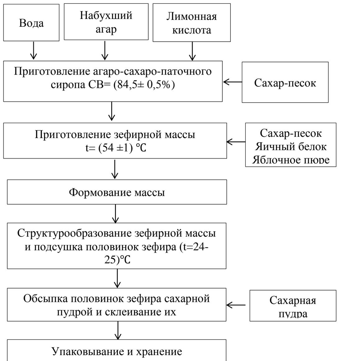
Рисунок 1 - Технологическая схема производства зефира
