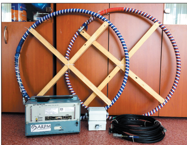
Три приёмника вместе — это интерферометр, который в разных точках Иркутска оценивает суммарное электромагнитное поле в зоне приёма
