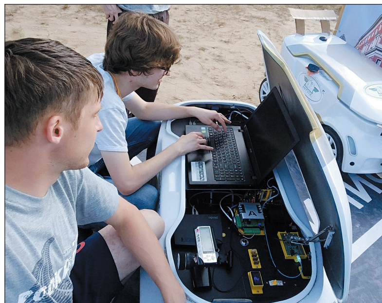
Беспилотник оснащён системой ГЛОНАСС, стереокамерой, системой управления и программирования
