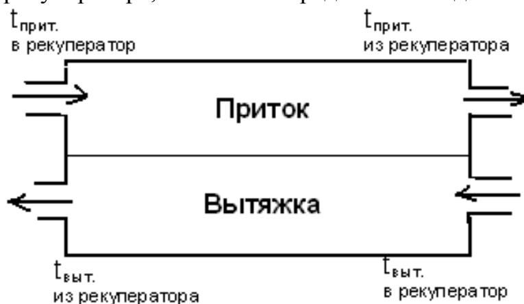
Рис. 1- Общий вид рекуперации тепловой энергии
