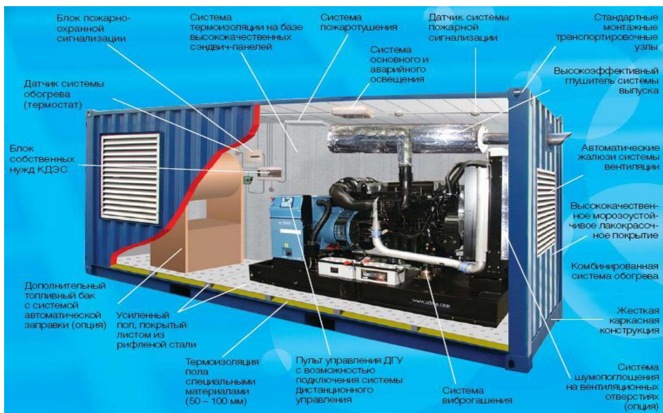
рис. 1 – устройство энергетического контейнера
