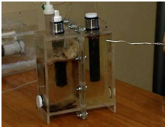
рис. 2 – конструкция микробного топливного элемента
