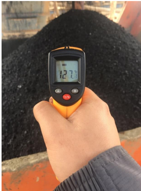
Рис.4 - Температура теплой асфальтобетонной смеси на выходе из смесителя АБЗ
