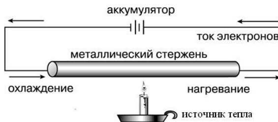
Рис. 2 - Опыт по нагреву одного из концов металлического образца при пропускании тока
