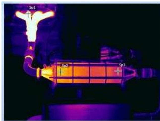
Рис. 3 - Тепловизионная съемка исследуемого теплообменника
