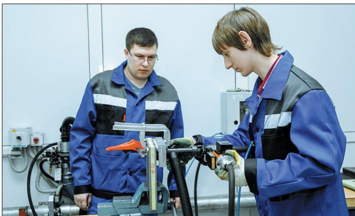
Аспирант Николай Чашин и магистрант Антон Стуров сверлят отверстия в образце, состоящем из титанового сплава и композита. Данная технология применяется при сборке самолета МС-21
