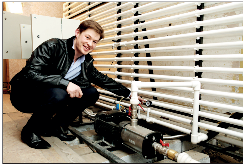
Молодой изобретатель построил имитационную модель трубопровода, управляемую специальной компьютерной программой. Разработка Дмитрия Киргина поможет обнаружить аварию на ранней стадии, что позволит избежать серьезных последствий
