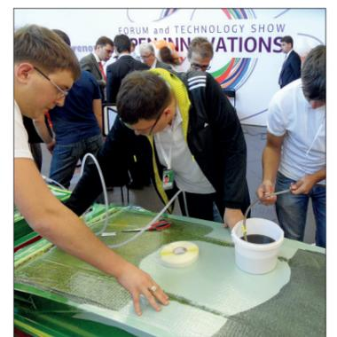
Процесс создания ПКМ — полимерных композиционных материалов
