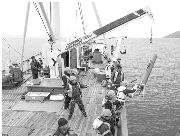
его разработке и изготовлении участвовали ученые и специалисты из Иркутска, Москвы и Санкт-Петербурга. Комплекс может погружаться на глубину до 1,6 тысячи метров. Испытания приборов, проведенные в июне этого года, показали, что гидроакустический комплекс может быть задействован не только в поиске
