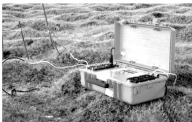
левых и демонстрационных работ. В частности, сотрудники инновационного предприятия ИРНТУ «Квазигеоид» применяли аппаратно-программный комплекс «Марс», измерительный прибор «Вега», многоэлектродную 16-ти канальную электроразведочную систему «Скала 64» и др. Эти аппараты находятся в собственности нашего университета, поэтому мы могли наглядно показать коллегам из других городов и стран возможность использования современной и качественной аппаратуры, - подчеркнул Юрий Давыденко.
