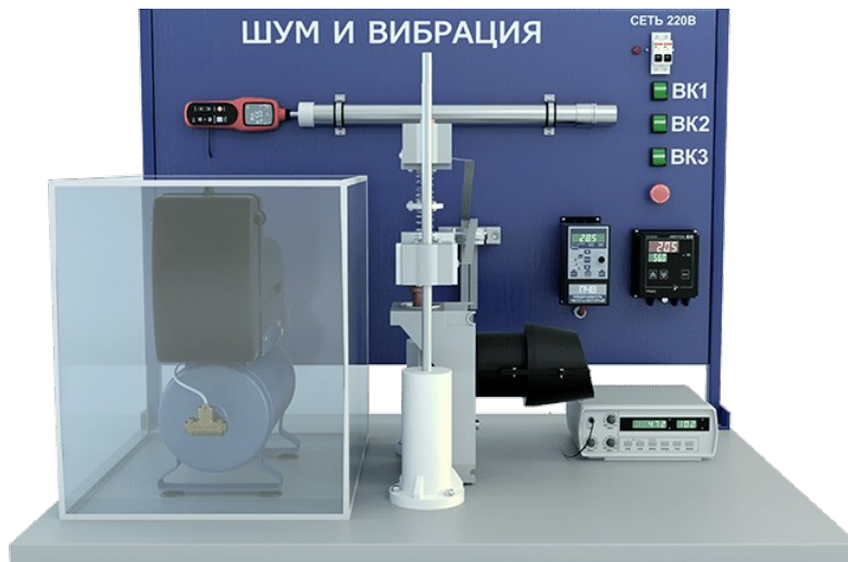
Рис. 6.2. Лабораторная установка для исследования уровня шума Быстросъемный звукоизолирующий кожух, позволяющий изолировать источники шума от микрофона, выполнен из оргстекла толщиной h = 6 мм.
