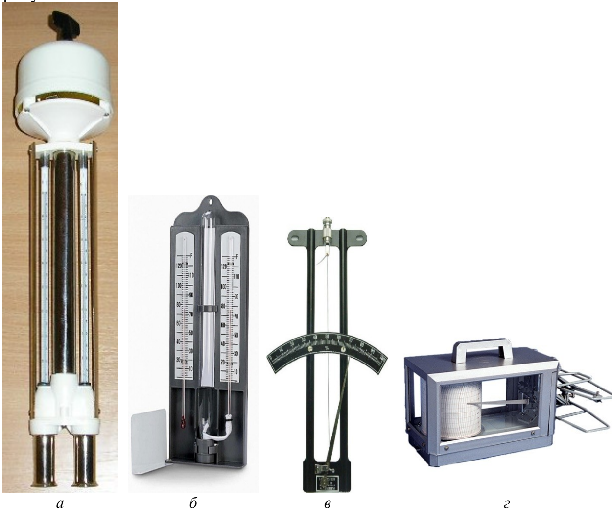
Рис. 2.3. Приборы для измерения относительной влажности воздуха: а – психрометр Ассмана; б – психрометр Августа; в – волосяной гигрометр; г – гигрограф
