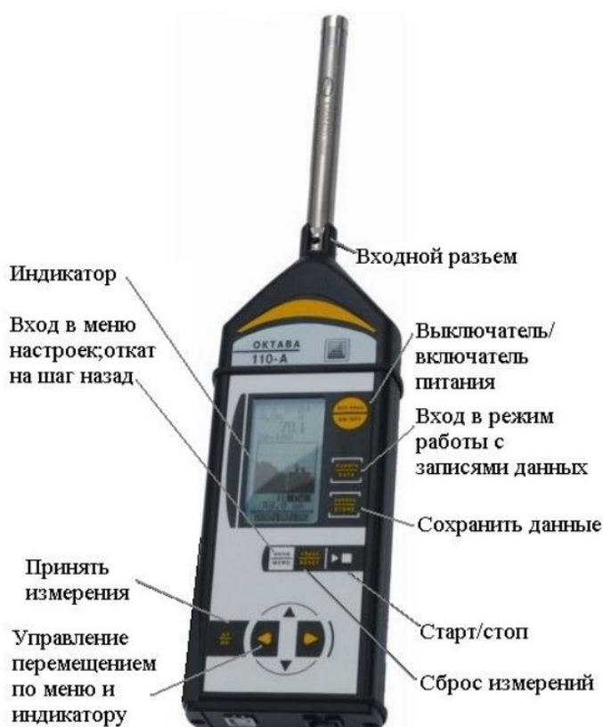
Рис. 6.1. Измеритель шума ОКТАВА 110-А
