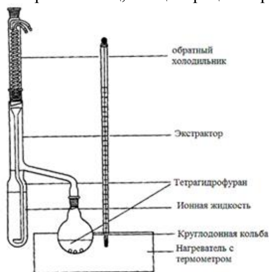
Рис. 1. Установка для непрерывной экстракции ионной жидкости
