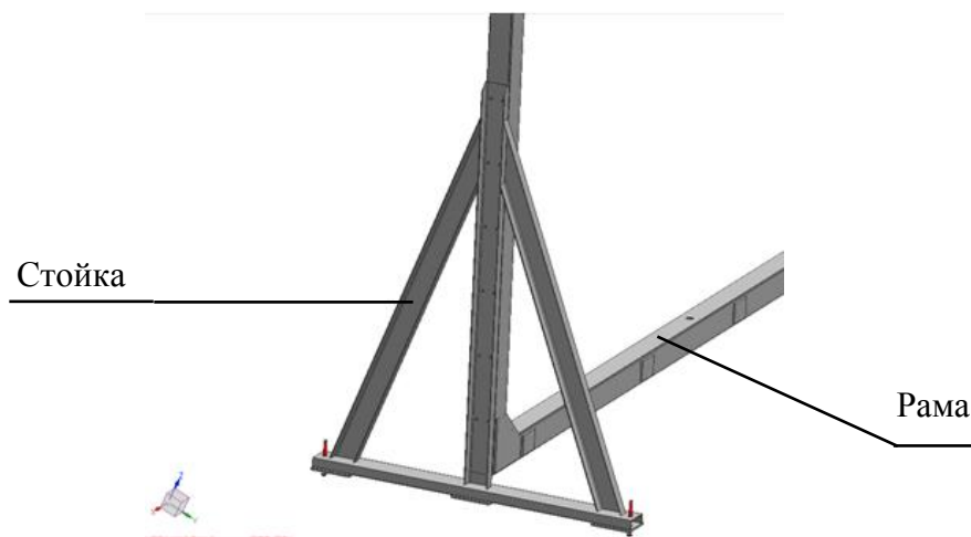
Рисунок 5.7 – Установка стойки сборочного приспособления
