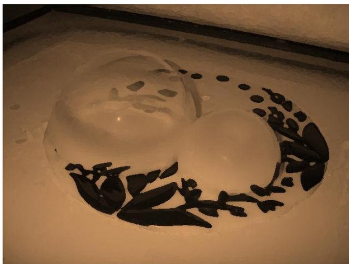
Рисунок 33 – Очевидный дефект стекла в виде пузырей при спекании
