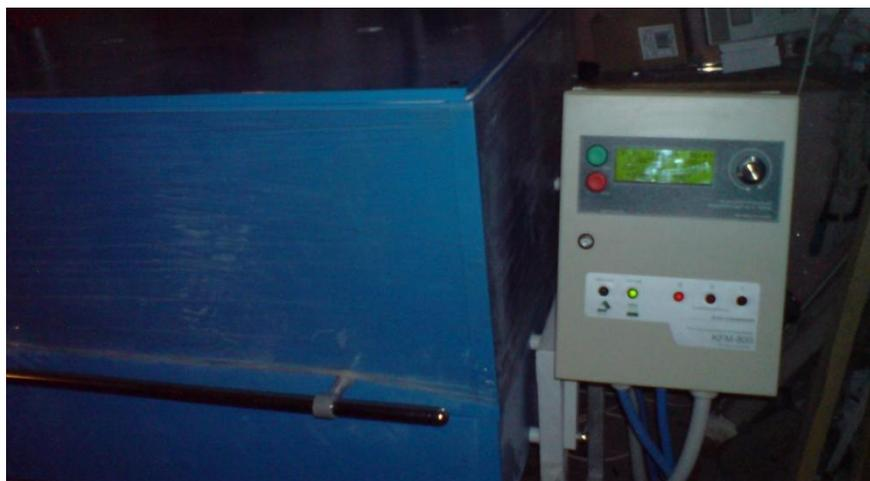
Рисунок 13 – Общий вид печи для фьюзинга и моллирования стекла KFM-800E с термоконтроллером
