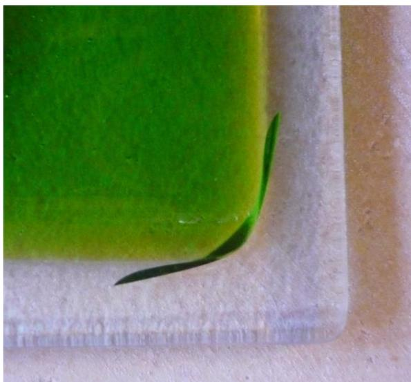
Рисунок 32 – Трещина в месте соединения двух пластин стекла
