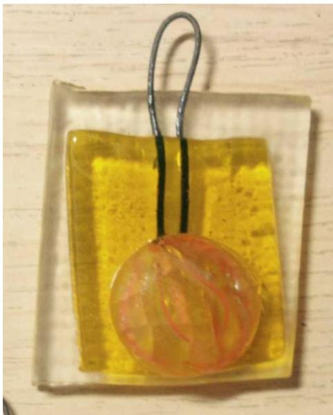
Рисунок 37 – Образец с петлеобразным подвесом из медной проволоки между пластиной подложки и накладкой из декоративного стекла
