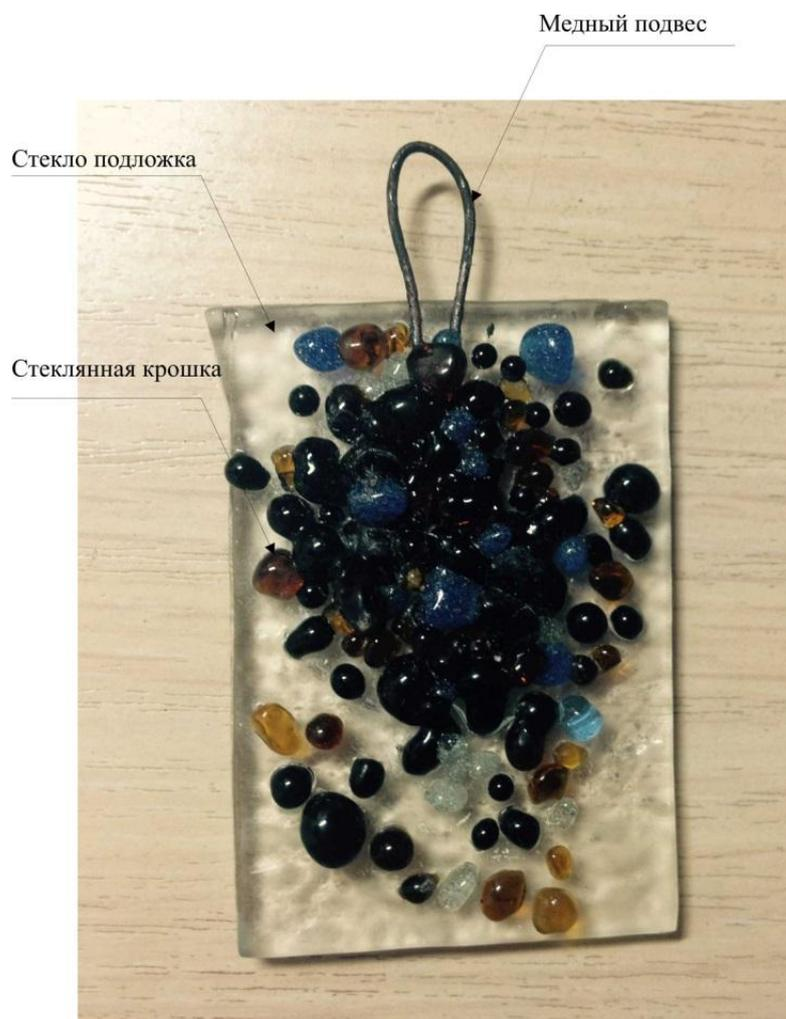
Рисунок 35 – Образец с петлеобразным подвесом из медной проволоки между пластиной подложки и стеклянной крошкой накладки
