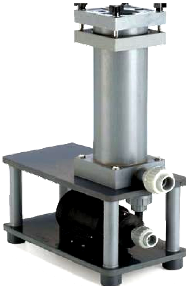
Рис. 7.3. Установка фильтрации гальванических растворов Labmaster фирмы «Серфилко». Одноколонная 1-3 картриджа 10 л . Материал – полипропилен, ПВХ, ХПВХ, PVDF. Насос герметичного исполнения. Скорость потока до 2500 л/ч.
