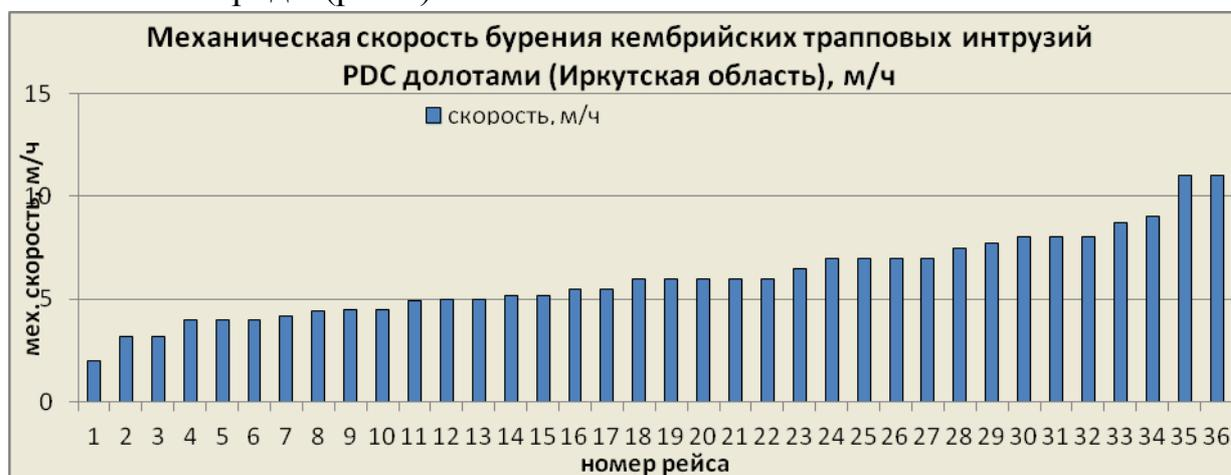
Рис. 3. Бурение трапповых интрузий (стопроцентное содержание долеритов) PDC долотами на месторождении Иркутской области
