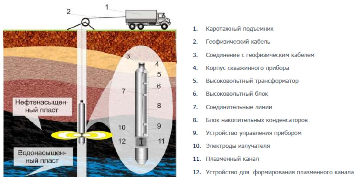
**Рис. 17. Используемое оборудование при спуске и состав прибора
