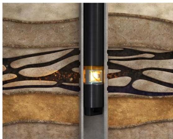
б) Иницируется взрыв проводника, происходит образование плазмы
