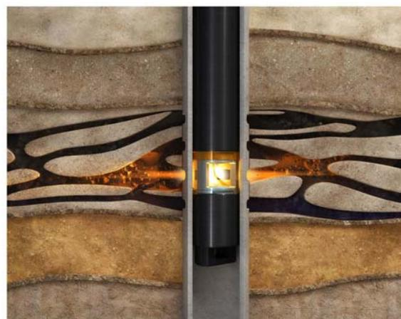
в) Расширяющаяся плазма создает ударную волну, которая через перфорационные каналы проникает в призабойную зону и далее в пласт
