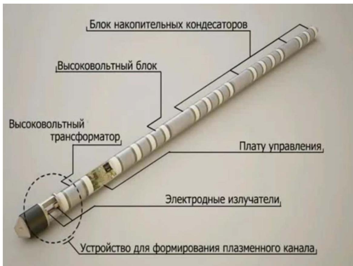
Рис. 16. Состав плазмодизельного генератора
