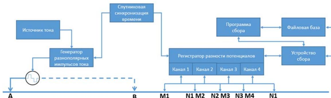
Рис. 10. Схема работы электроразведочного комплекса
