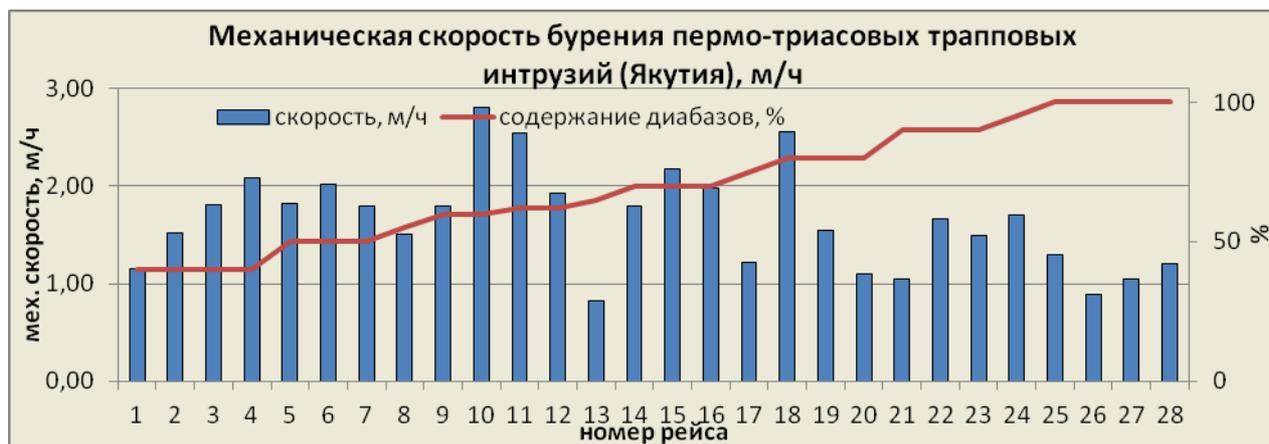
Рис. 1. Бурение трапповых интрузий трёхшарошечными долотами с IADC кодом 627Y на месторождении Республики Саха (по степени увеличения содержания диабазов)
