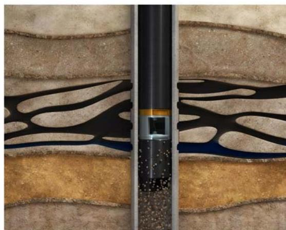
г) Сжатие и охлаждение плазмы приводит к выносу закупоривающих осадков в ствол скважины, а ударная волна переходит в объемную упругую волну
