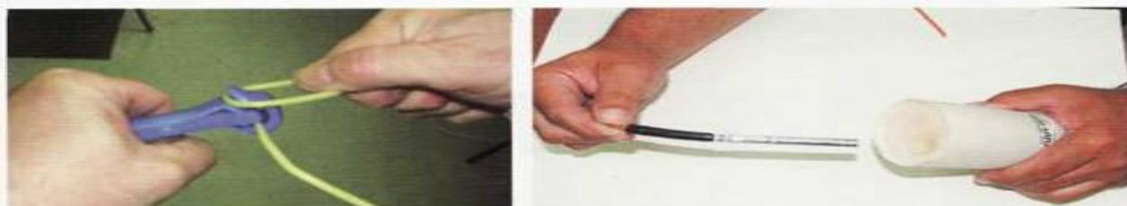
Рис. 7. Монтаж поверхностной сети и изготовление боевика
