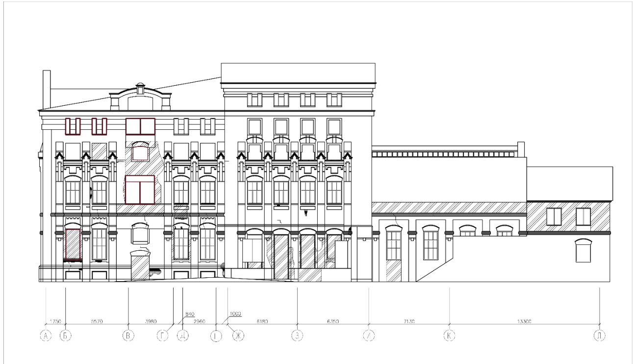
Рис.34. Чертёж дефектов северного фасада
