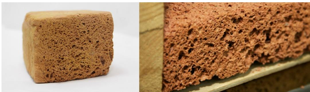
Использование золы в качестве наполнителя удешевляет стоимость теплоизоляции, снижает способность к распространению пламени по поверхности и дымообразующую способность, что соответствует требованиям ФЗ № 123 по пожарной безопасности строительных материалов.
