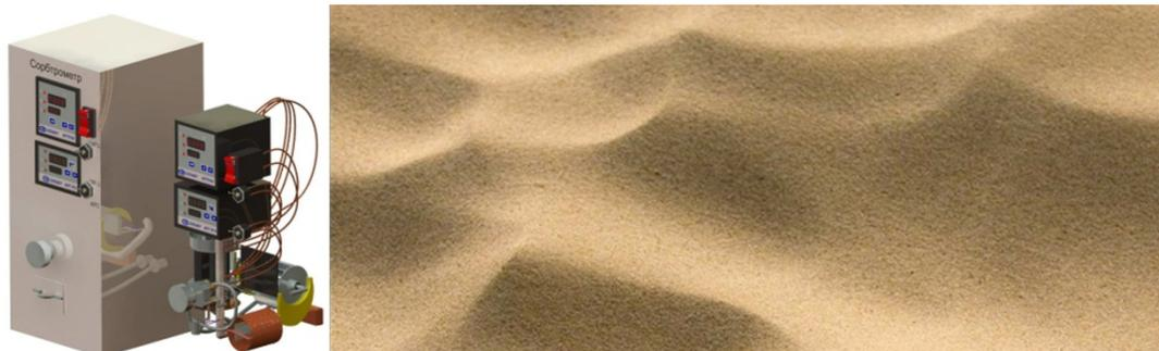
Метрологические характеристики: диапазон измерения 0,5–1000м<sup>2</sup>/г, производительность 5 проб/час, погрешность  $\Delta = \pm(2.5)\%$ .
