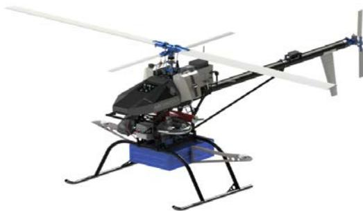
Самым технологичным методом съёмки крупных по площади территорий по праву считается воздушная лазерная локация. Комплекс инновационного оборудования, включающего в себя лазерный сканер, мультиспектральные и фото камеры, спутниковые навигаторы и инерциальные системы, с недавних пор может быть размещён на беспилотном летательном аппарате (вертолёте или самолёте).
