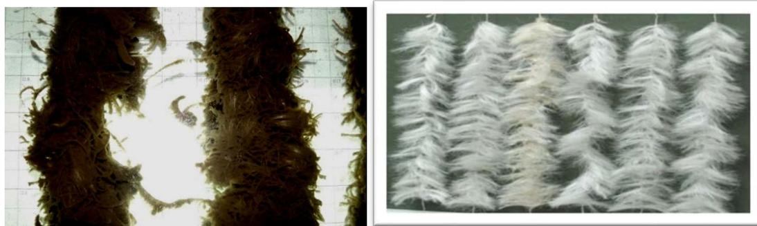
Предложены водо-воздушная и механическая регенерации иммобилизованного ила на синтетической ершовой загрузке расположенной в аэротенке-биореакторе.
