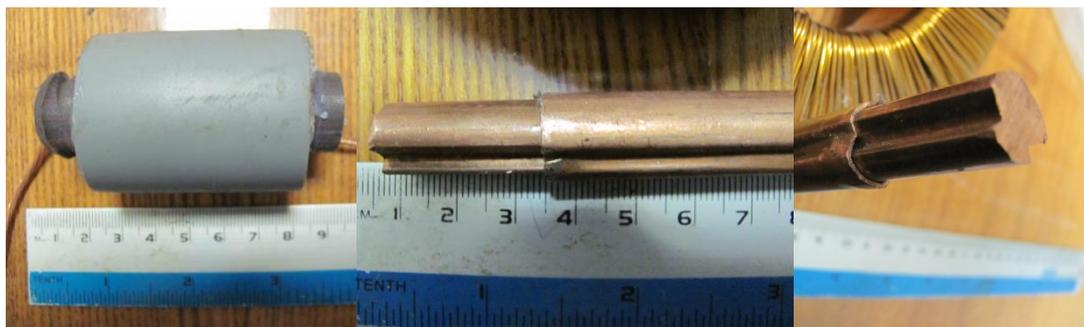
Инновационная разработка в области электроэнергетики, заключающаяся в создании при монтаже контактного электрического соединения жил проводов и кабелей электровзрывным способом, что обеспечивает снижение потерь электрической энергии в распределительных электрических сетях.
