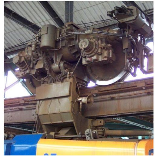
Рис. 3 - Вуппертальская подвесная дорога; общий вид подвесной системы (Германия)
