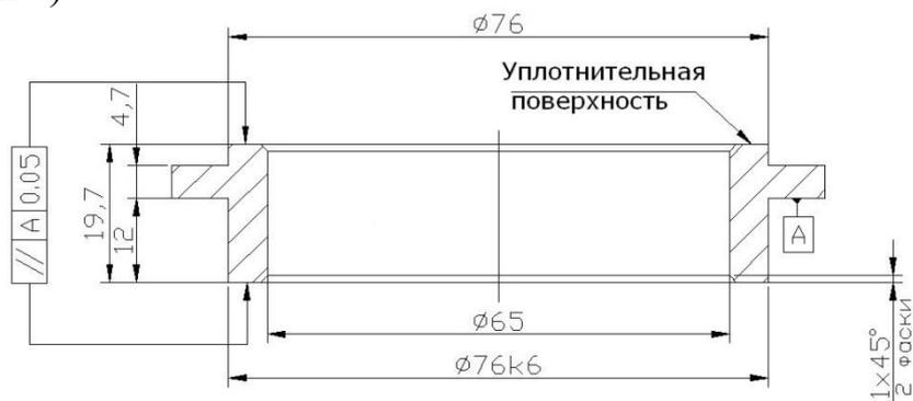
Рис. 2 - Опытная деталь имитирующая «седло» клапана низкого давления DN 65
