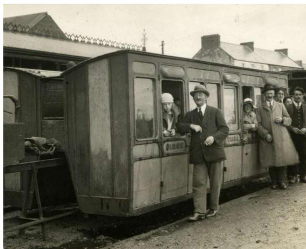
Рис 4. - Монорельсовая дорога между Бейли Юнионом и Килларни 1935г (Ирландия). Для того чтобы обеспечить равновесие вагонов относительно центрального рельса пассажиров рассаживали равномерно «по массе»
