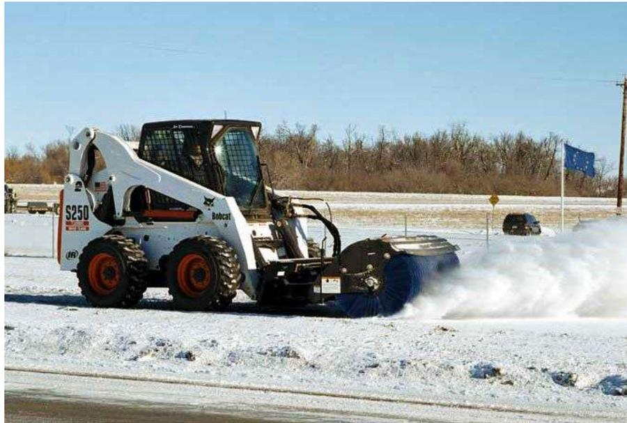
Рис. 1 Рабочий процесс отбрасывания снега щеткой
