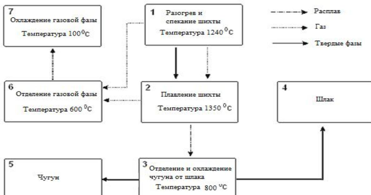
Рисунок 1. Блок-схема 7-резервуарной модели восстановления железа и цинка из пылей электросталеплавильного производства
