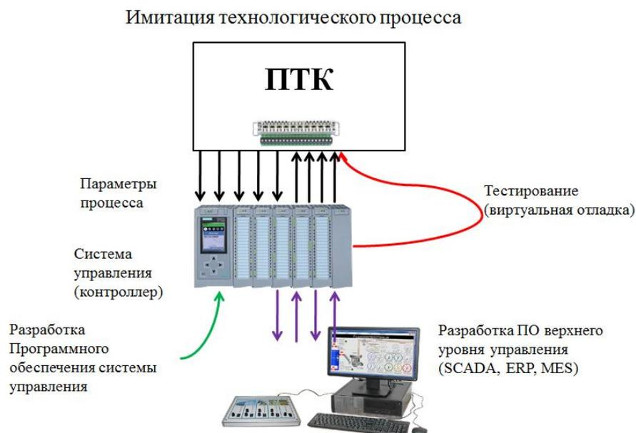
Рисунок 3 - Взаимодействие ТТК с периферийными устройствами
