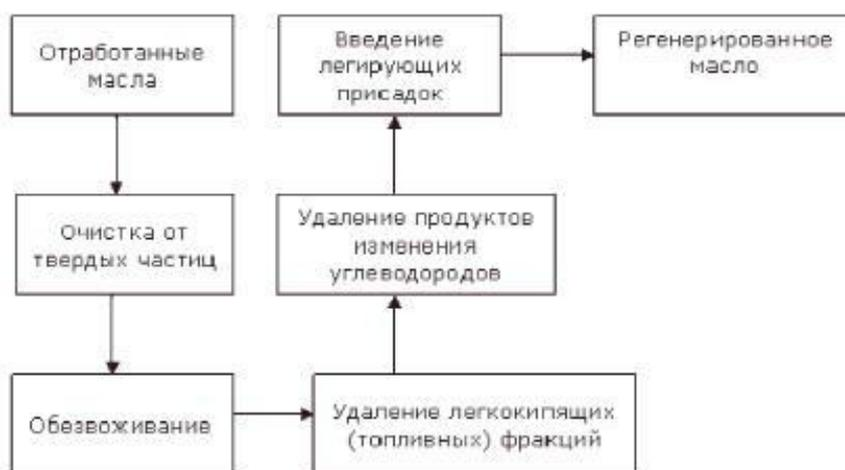
Рисунок 1 - Стадии процесса регенерации отработанных автомобильных масел
