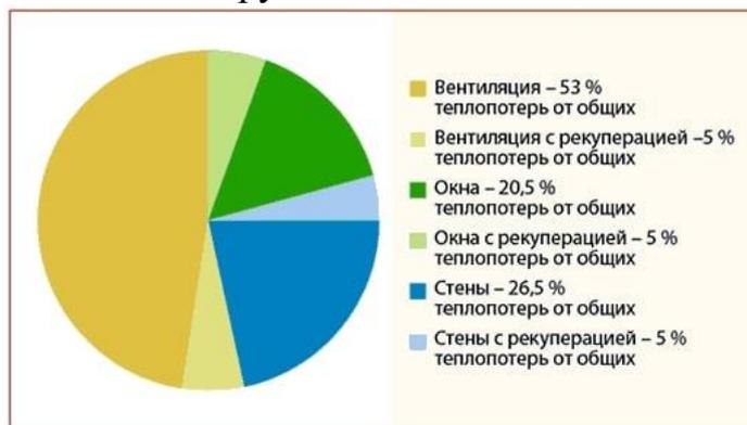
Рисунок 1 - Диаграмма теплопотерь в многоэтажных домах типовых серий в соответствии планами на 2016 год (стены, окна, вентиляция) до и после внедрения системы активного энергоснабжения.
