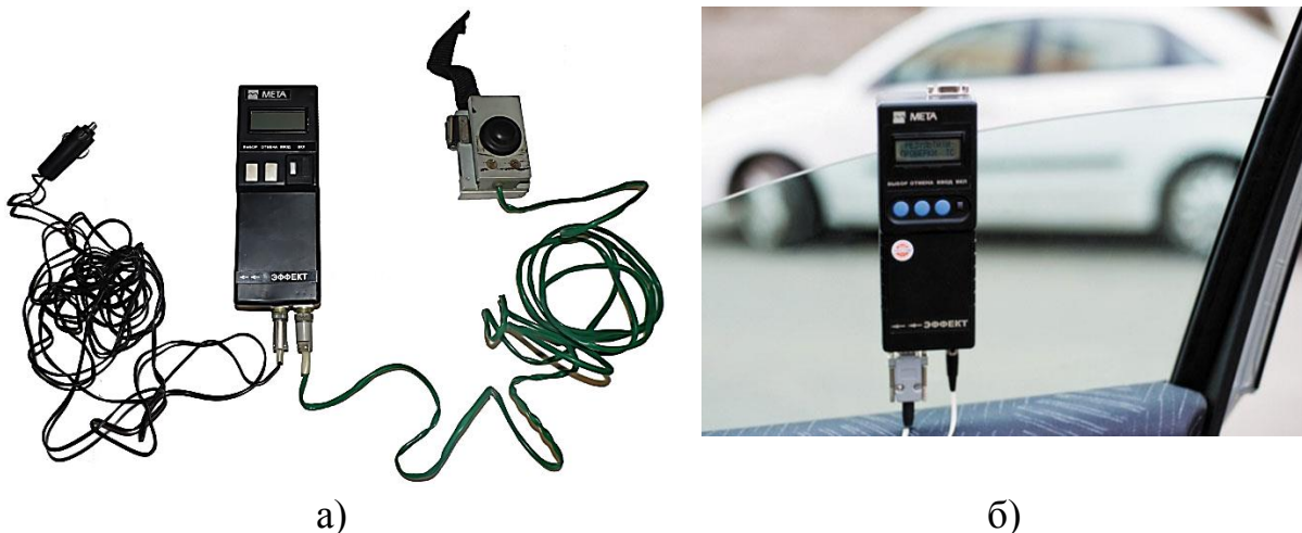
Рисунок 2 - Прибор «Эффект-02»: а) общий вид прибора; б) прибор, установленный на переднем стекле автомобиля
