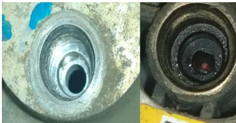
Рисунок 1 - Образование влаги на компонентах пневмосистемы
