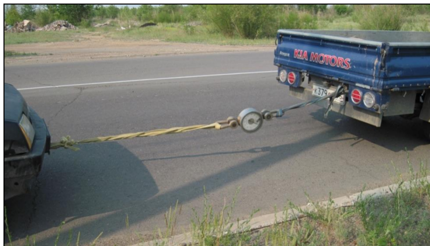
Рисунок 3 - Автомобиль ВАЗ-2108 с полностью заторможенными колесами тянут на буксире, установив между тягачом и буксируемым автомобилем динамометр
