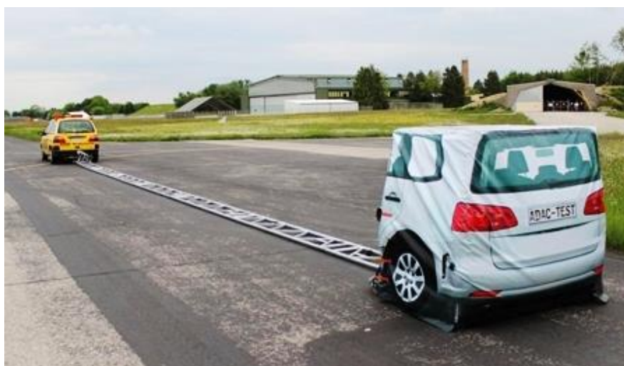
Рисунок 3 - Автомобиль-цель, предусмотренная методикой EuroNCAP [5]
