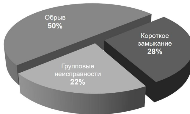
Рисунок 1 - Неисправности выпрямителей автомобильных генераторов
