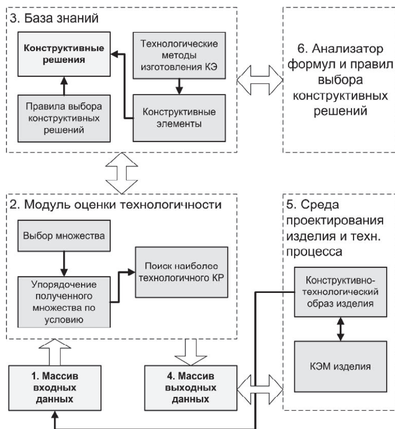
Рис. 4. Модель обеспечения ТКИ на стадии проектирования
