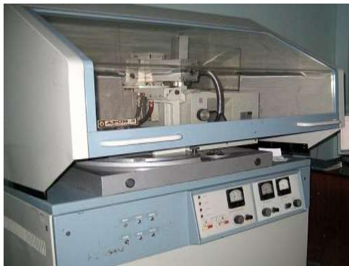
Рисунок 1. Дифрактометр ДРОН-3 для съемки рентгенограмм
