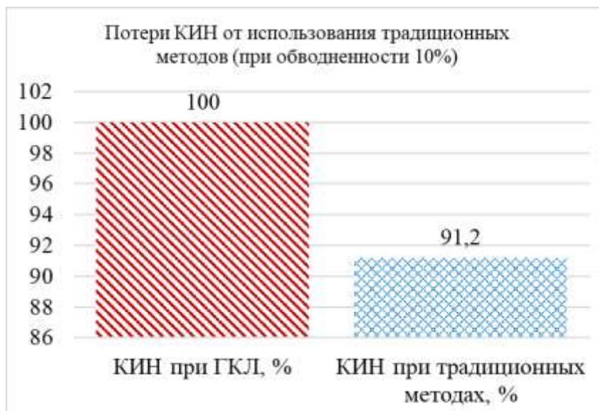
Рисунок 2. Увеличение коэффициента извлечения нефти от применения технологии греющих кабельных линий
