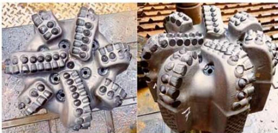
Рисунок 1. Долото StingBlade Z716 после бурения всей секции
