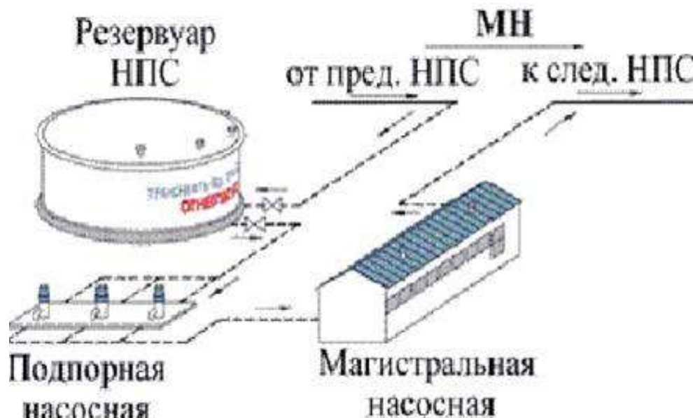
Рисунок 2 – Технологическая схема НПС - 12
