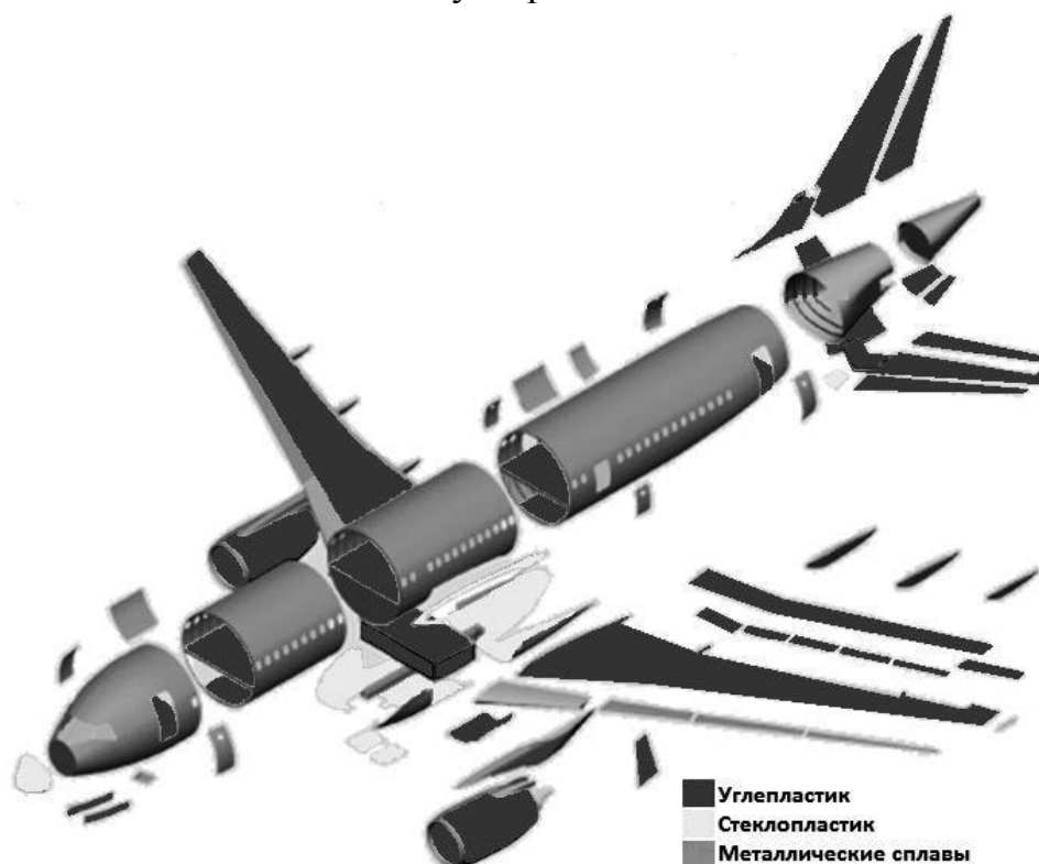
Рисунок 2. Членение самолёта MC-21
