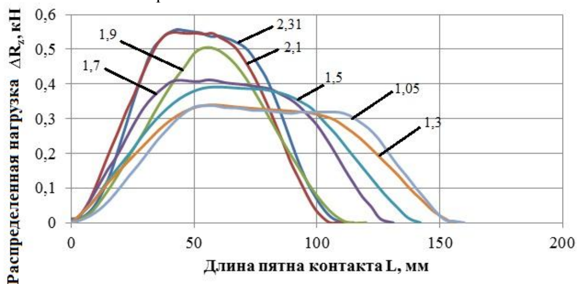
Рис. 5. Графики нормальной распределенной нагрузки \Delta R_z с разным давлением в шине при качении колеса по ровной поверхности дороги
