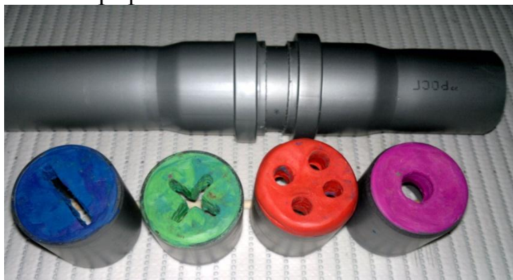
Рис. 2. Макеты поисковые пластилиновые в масштабе 1:5 внешних и внутренних форм УПС
