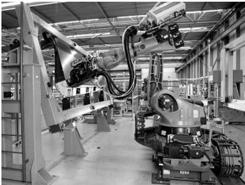
Рисунок 1 – Шести осевой робот фирмы KUKA в процессе клёпки закрылка самолета Airbus A350 [4]
