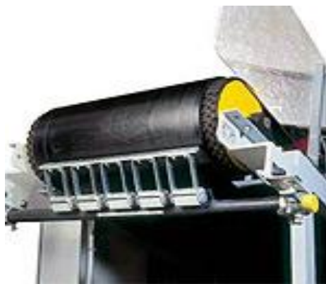
Рис. 4. Твердосплавный скребок с фронтальным расположением сегментов
