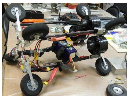
Рисунок 5. Радиоуправляемый теледиагностический комплекс с импеллерными двигателями
