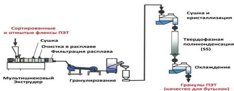
Рис. 2 Схема механической обработки пластика.
