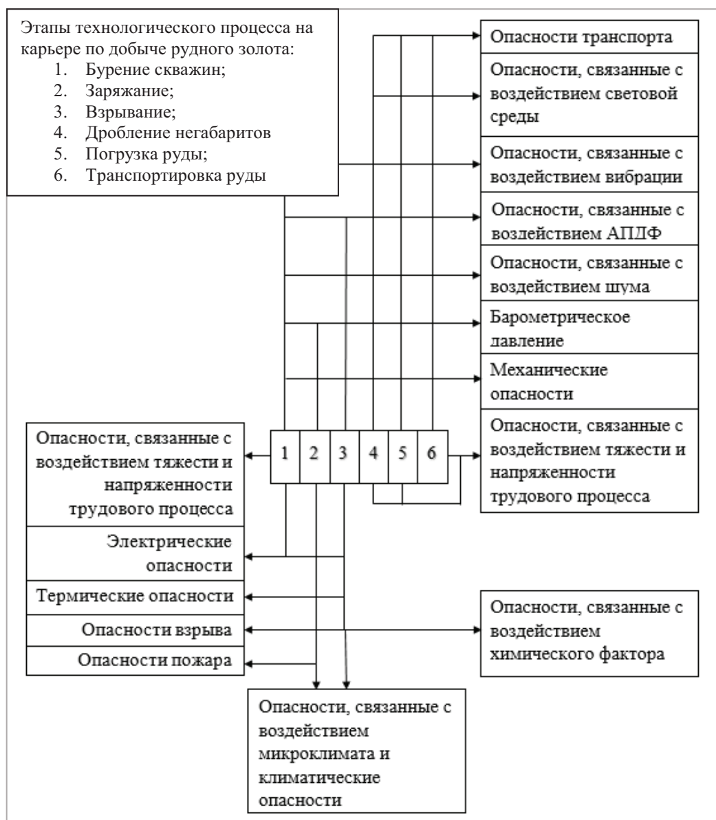
Рис. 1. Схема распределения видов опасностей на основных этапах технологического процесса по добыче золотосодержащей руды на карьере
