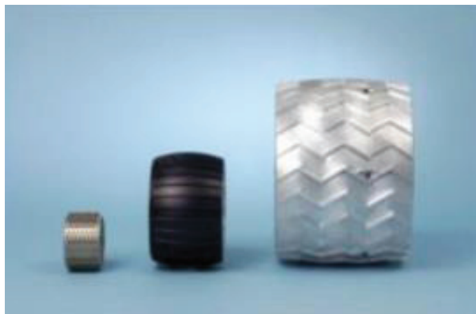
Рис. 2. Колеса МРП диаметром (слева направо): 0,33 м; 0,26 м; 0,5 м
