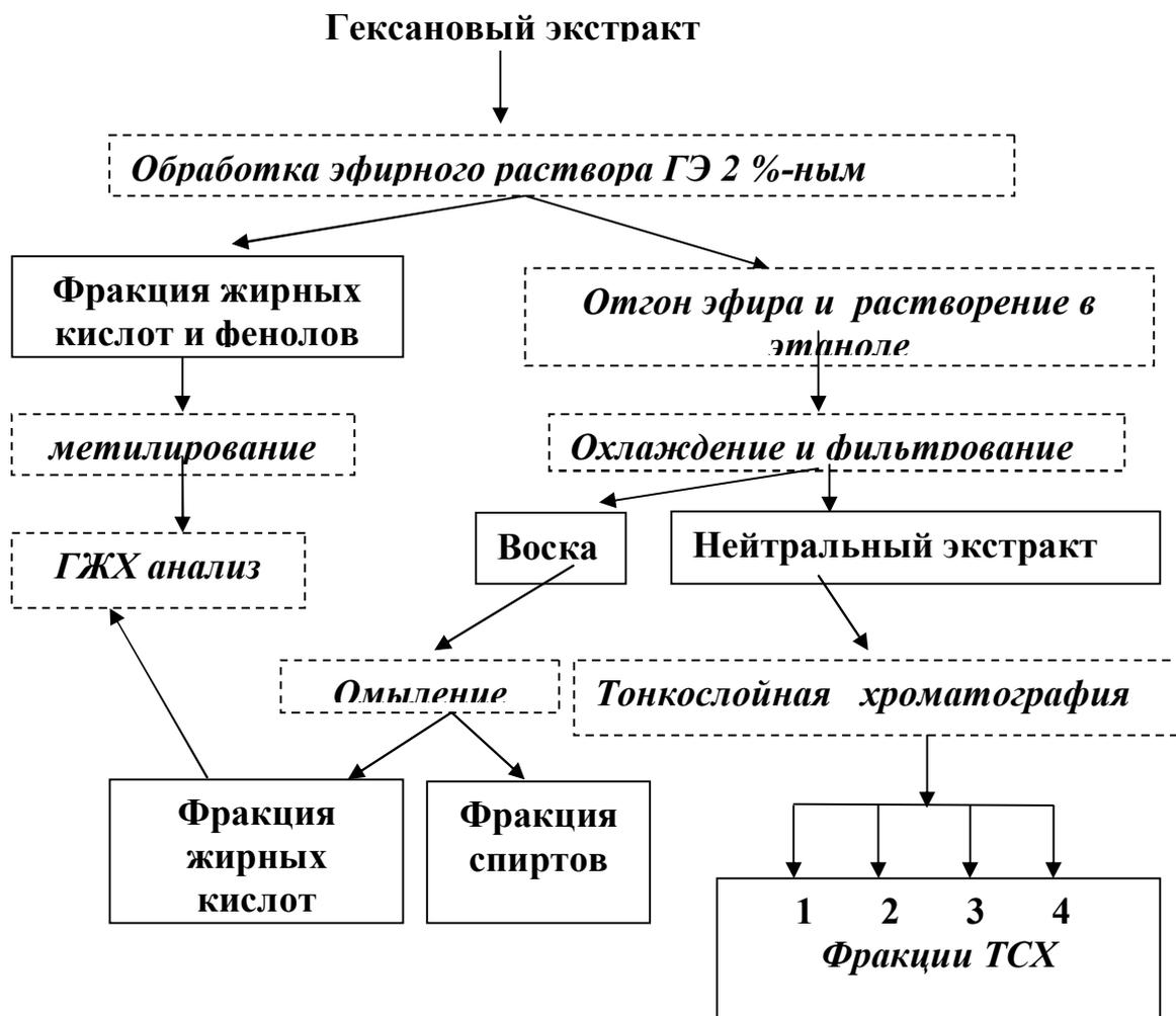
Рисунок. Схема фракционирования гексановых экстрактов
