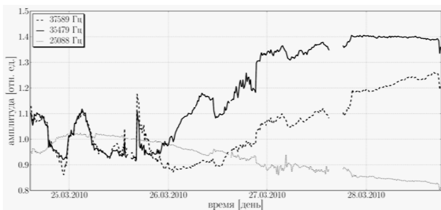
Рис. 3. Изменения относительной амплитуды сигнала на приёмном гидрофоне R2, отстоящем от излучателя TL на 35 м
