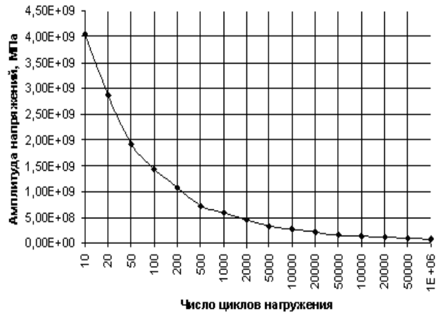
Рис.3. Кривая усталости для углеродистых сталей до температуры 380°C
