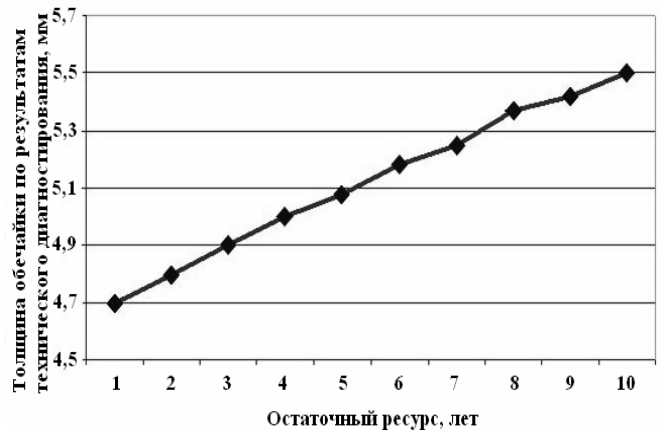
Рис. 8. Зависимость остаточного ресурса воздухоборника В-3,2 от толщины, определенной по результатам технического диагностирования
