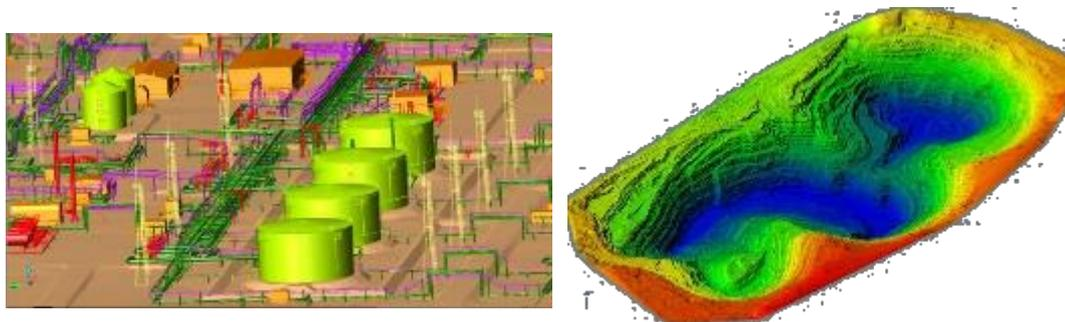
Для определения точности переноса проекта сооружения в «натуру» и выявления отклонений, возникающих в период строительства, для получения координат и высот построенных объектов и других данных, необходимых для составления исполнительных планов, выполняется контрольно-исполнительная съемка с использованием технологии наземного лазерного сканирования.
