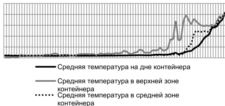
Рис. 10. Изменения температуры внутри контейнера
