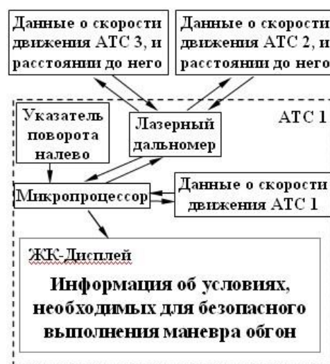
Рис. 13 – Схема работы подсказывающего устройства
