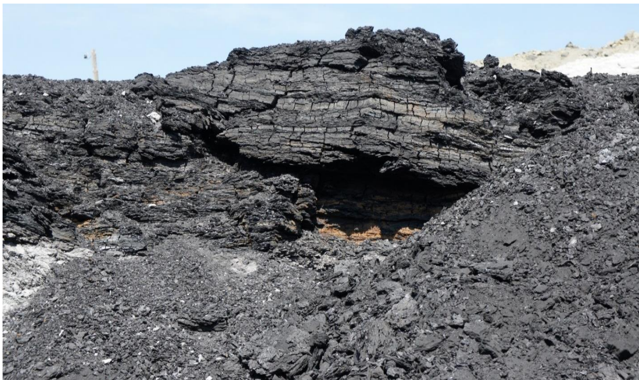
Рисунок 2.35 Очаг самовозгорания бурого угля после выгорания. Разрез Харанорский
