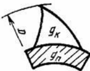
Рисунок 2.39 Геометрические параметры ковша роторного колеса экскаватора
