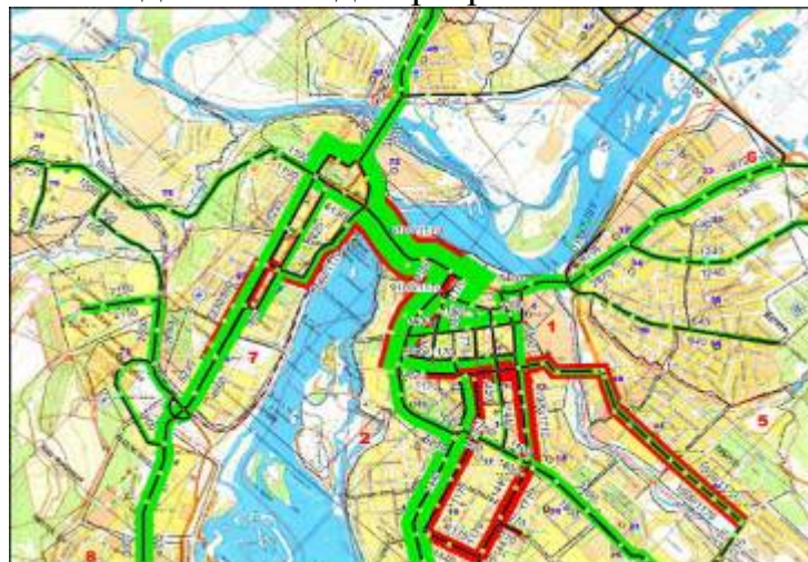
Оценка состояния системы общественного пассажирского транспорта г. Иркутска 2006 г. – картограмма провозной способности общественного пассажирского транспорта
