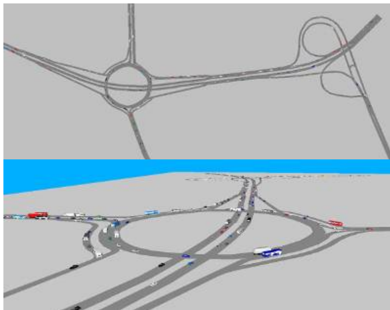
Фрагменты процесса моделирования предлагаемого TL-ISTU варианта левобережного подхода к строящемуся мосту через р. Ангару
