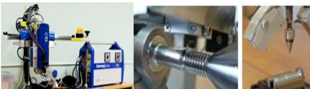
Разработаны технологии измерения остаточных напряжений разрушающим и неразрушающими методами, а также оптимизации на их основе параметров технологических процессов. Разработана и изготовлена уникальная установка для измерения остаточных напряжений УДИОН-2. Получено свидетельство о государственной регистрации программного обеспечения.
