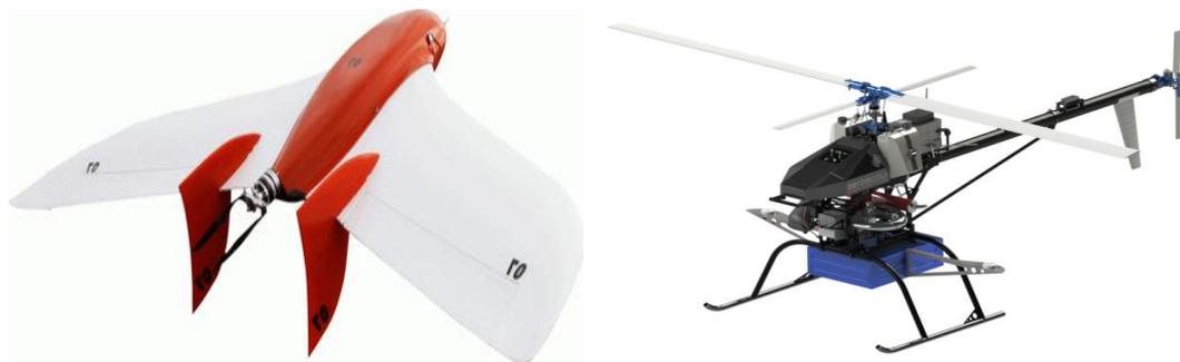
Самым технологичным методом съёмки крупных по площади территорий по праву считается воздушная лазерная локация. Комплекс инновационного оборудования, включающего в себя лазерный сканер, мультиспектральные и фото камеры, спутниковые навигаторы и инерциальные системы, с недавних пор может быть размещён на беспилотном летательном аппарате (вертолёте или самолёте).
