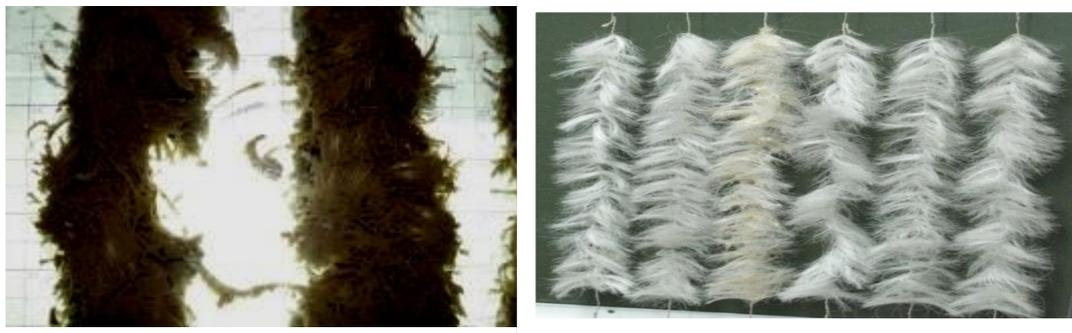
Предложены водо-воздушная и механическая регенерации иммобилизованного ила на синтетической ершовой загрузке расположенной в аэротенке-биореакторе.
