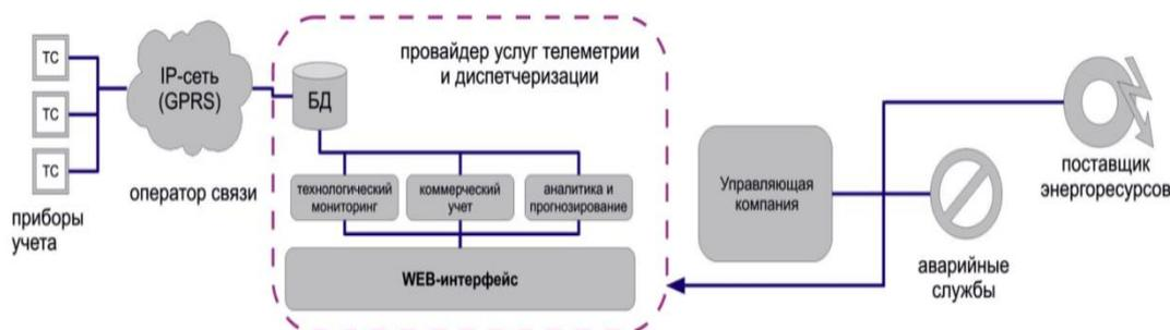
Разработана информационно-измерительная система учета теплотребления, обеспечивающая:
