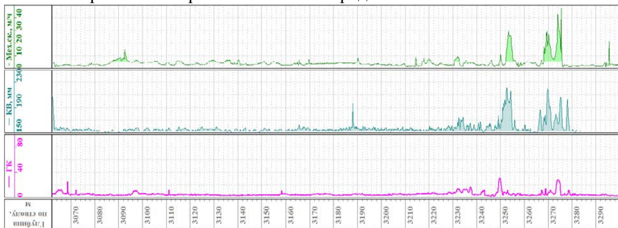
Рис.1. Дискретность (!) поглощающих интервалов разреза в горизонтальном стволе, рифей. Скачкообразное изменение механической скорости при вскрытии высокопроницаемых разломных зон. Провал КНБК на гл. 3252м, катастрофическое поглощение. По данным горизонтального бурения скважины ХХУ, Юрубченская залежь, ЮТМ.
