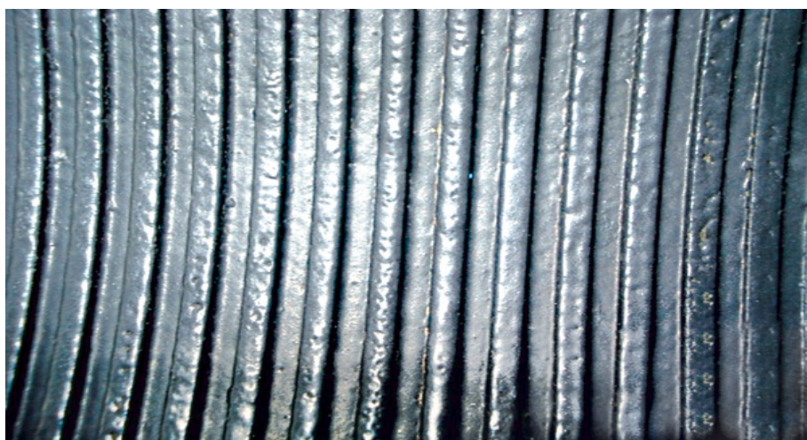
Рис. 2. Внешний вид резьбы Баттресс производства ОАО «ТАГМЕТ» с фтор-полимерным самосмазывающим сухим покрытием «МАОК-ПЛАУН™»
