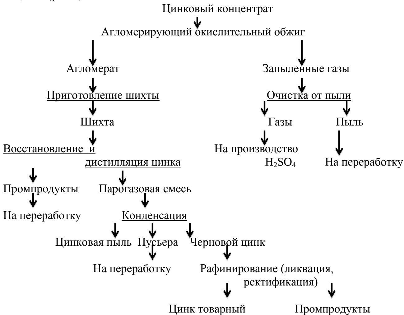
Рис. 1. Схема пирометаллургического способа переработки цинковых концентратов
