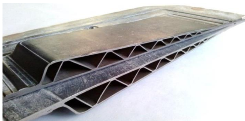
Рисунок 18 – Разрез трёхслойной клиновидной панели с переменным шагом ребер из сплава ОТ4-1
