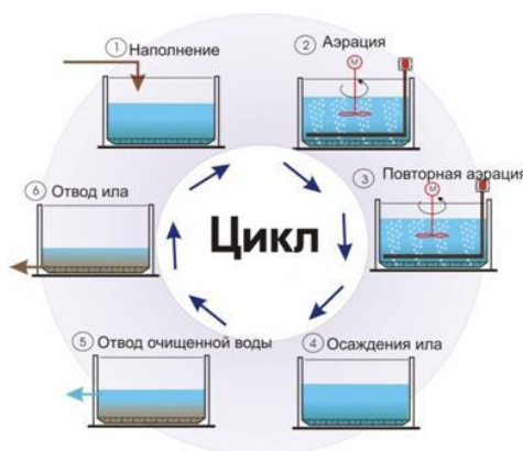
Рис. 2. Схема очистки сточных вод с помощью реактора последовательно-переменного действия
